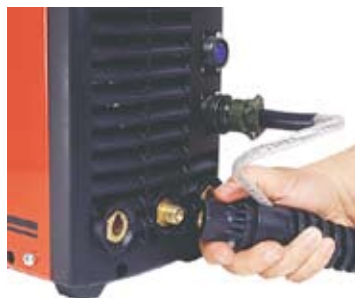
Подключение горелки с газовым охлаждением
